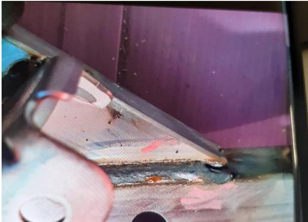
Das Bild zeigt eine Fehlstelle am Schweißnahtende.
