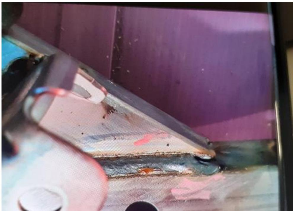
**La imagen muestra un defecto en el extremo del cordón de soldadura.**
